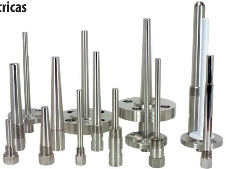
Las vainas termométricas son utilizadas para proteger el inmersor de los efectos corrosivos, de la presión, de la alta velocidad del fluido de proceso y para permitir la movilidad del termómetro para su recalibración y/o sustitución, sin entorpecer el proceso.
